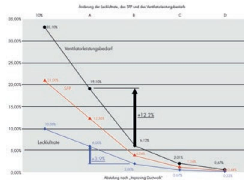
Reduziert sich beispielsweise die Leckluftrate nur von der Dichtheitsklasse A nach B um ca. 4%, so sinkt der Leistungsbedarf des Ventilators bereits um 12,2%.
